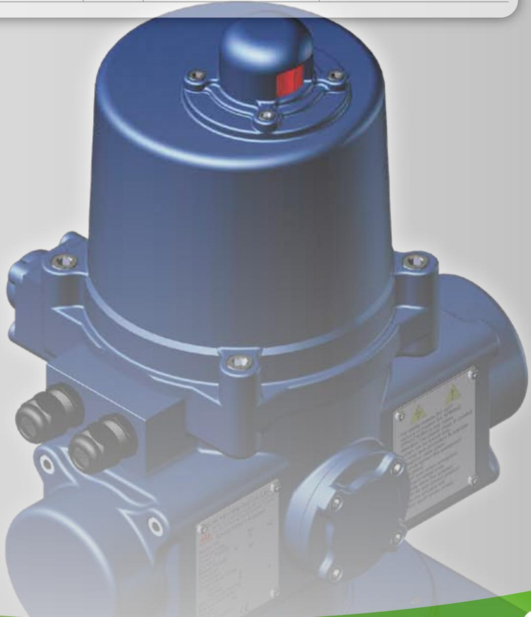
Industrieantrieb mit Sicherheitsfunktion mittels Federkraft. Alle Modelle verfügen über eine permanente mechanische Positionsanzeige im Gehäusedeckel des Antriebs. Kabelverschraubung M20, Gehäuse: Aluminium pulverbeschichtet, IP67, Montage ISO5211, Die Betriebsanleitung ist unbedingt zu beachten!
